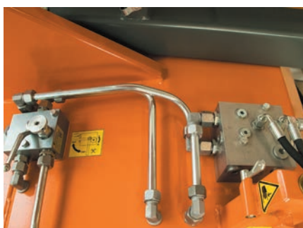
bema SideControl et bloc de commande hydraulique
