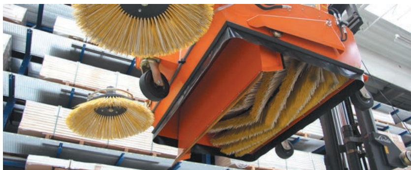
Garniture du rouleau à rotation gauche et droite en vue du nettoyage optimal des sols
