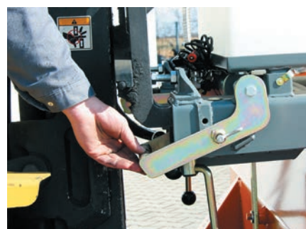
Verrouillage du logement sur chariot élévateur
