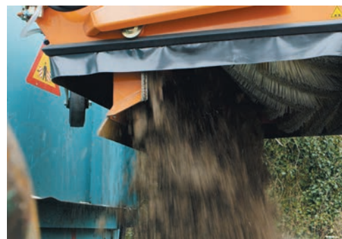
Vidage en hauteur par-dessus le conteneur
