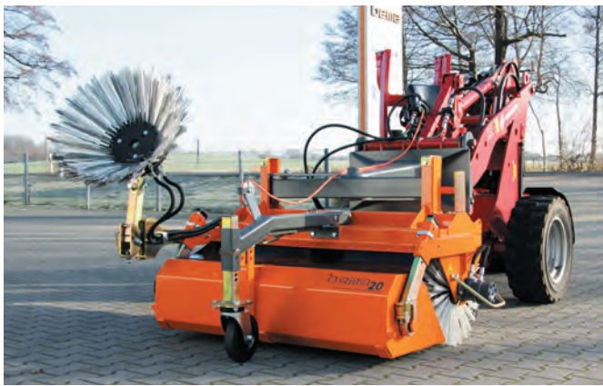
Entleerung der Sammelwanne mit Seilzug (mechanisch), Seitenkehrbesen
