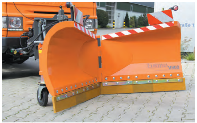
bema V-Schild V800 in Y-Stellung am Kommunalfahrzeug
