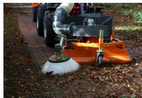
bema Saug-Kehrdüse mit Häckselgebläse
