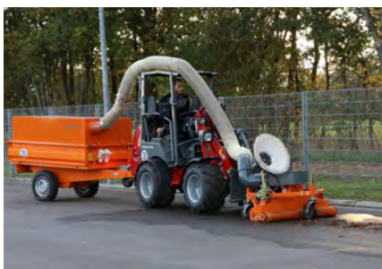
bema Saug-Kehrdüse mit Häckselgebläse und einem Seitenkehrbesen (Sammelsystem im Heck)
