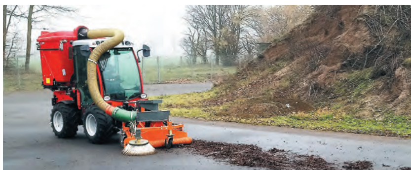
bema Saug-Kehrdüse mit Häckselgebläse angebaut am Trägerfahrzeug mit Sammelcontainer
