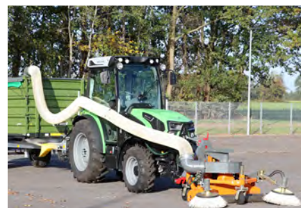
bema Saug-Kehrdüse mit Häckselgebläse und zwei Seitenkehrbesen (Sammelsystem im Heck)
