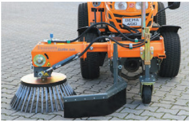
Flexibel dank der teleskopierbaren seitlichen Verschiebung (300 mm)
