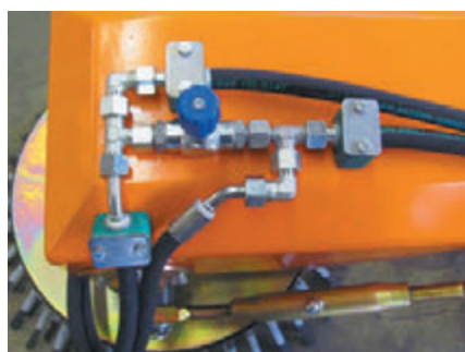
Drehzahlregulierung des Tellerbesens
