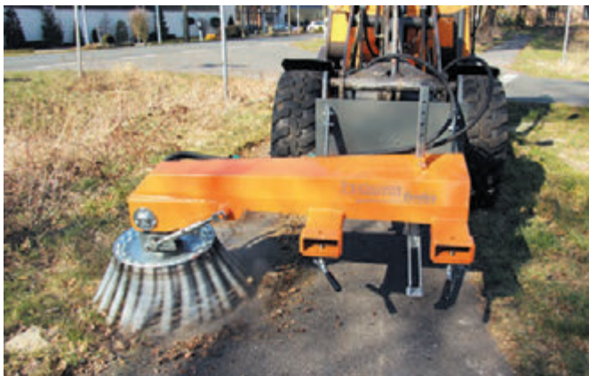
bema Groby mit Stapleraufnahme
