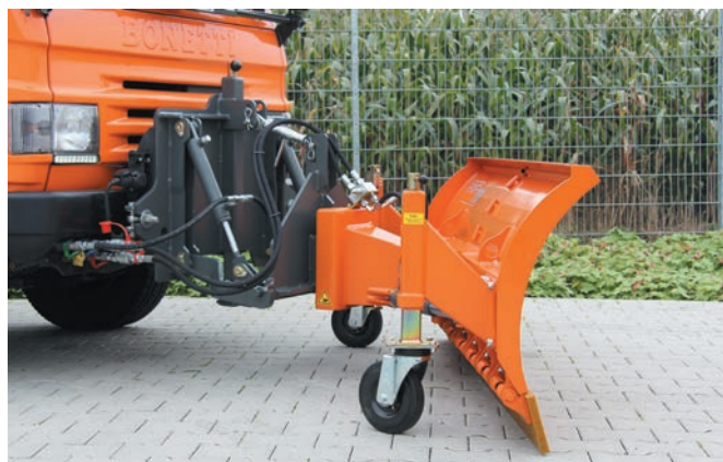
Lame à neige bema série 700 munie d'un dispositif de levage
