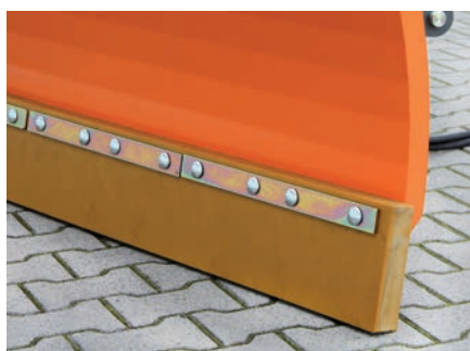
Segments de volets à ressort avec une garniture en PU
