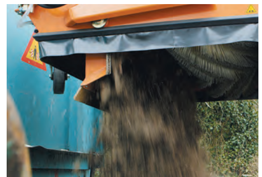
Hochentleerung über Container
