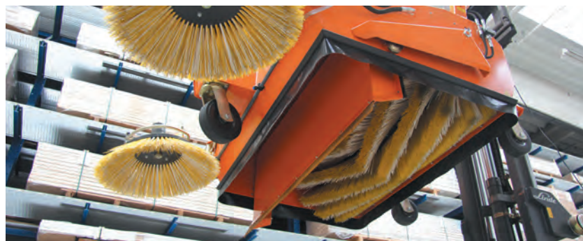
Kehrwalzenbesatz mit links- und rechts-Drall zur optimalen Reinigung der Böden
