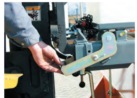
Verriegelung der Aufnahme am Gabelstapler
