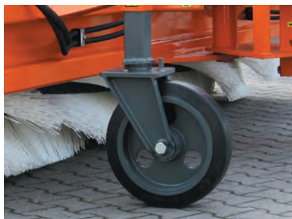
Stabile Laufräder (Gussfelge mit Radlager)
