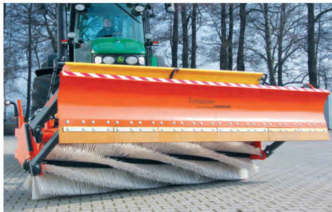
bema Snow-Combi mit hochgeklappten Schneeschild - Freikehren
