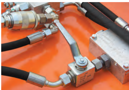
Schwenkdrossel & Mengenteiler (gleichmäßiges Anheben des Schneeschildes)
