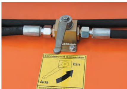
Absperrhahn zum Verriegeln des hochgeklappten Schneeschildes
