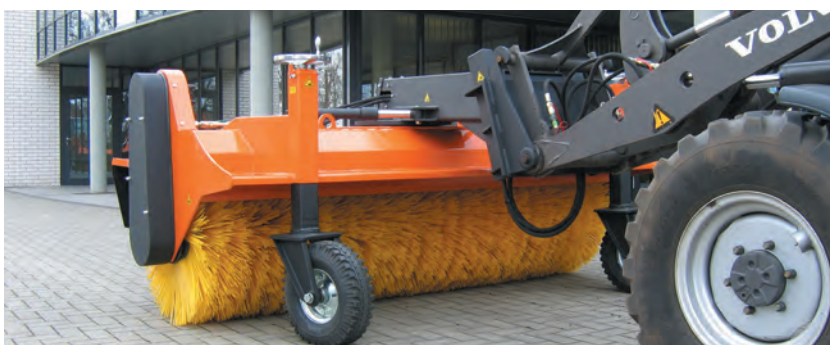
bema Jumbo am Radlader (Schnellwechselanbau mit Rollenniveaueingleich)
