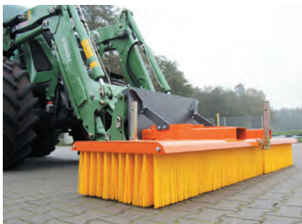
Schnellwechsellanbau für Frontlader (Euronorm)
