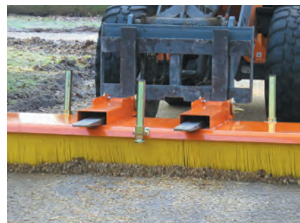
Palettenaufnahme mit werkzeugloser Arretierung
