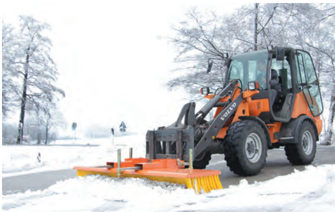
Einsatz im Winterdienst: bema 11 Multi-Clean am Radlader
