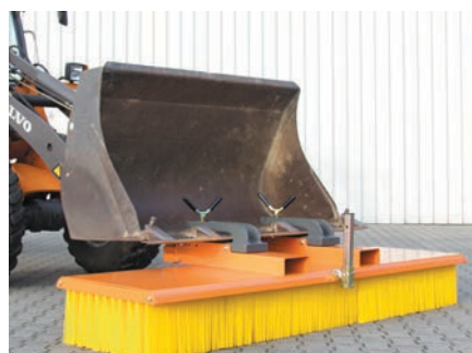
Logement pour godet y compris vis de serrage
