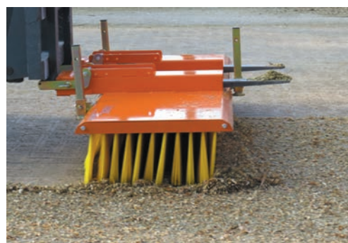
Le balai pousseur s'impose par 11 rangées de brosse
