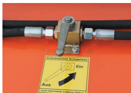
Absperrhahn zum Verriegeln des hochgeklappten Schneeschildes
