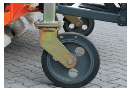
Stabile Laufräder Ø 360 x 85 mm, Verstellung mittels Kurbel
