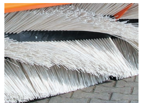
Schneekehrwalze PPN (Spiralsegmentbesatz)
