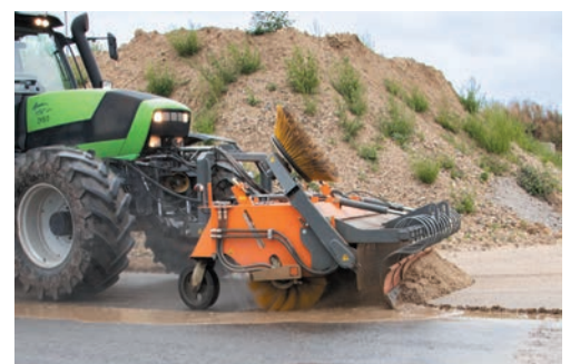
PowerMaster ausgestattet mit Aufkratzvorrichtung und Seitenkehrbesen, jedoch ohne Schmutzsammelwanne.
