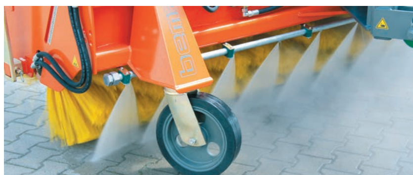
Hochdruckspülanlage - je nach Maschinenbreite bis zu 11 Hochdruckdüsen
