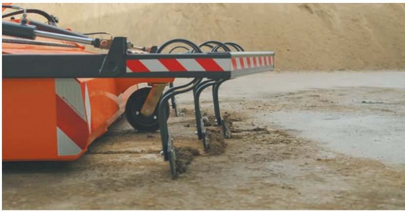
Aufkratzschiene unterteilt in hochverschleißfeste Stahlsegmente
