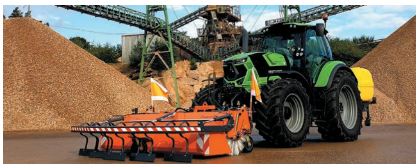
bema PowerMaster Kehmaschine ausgestattet mit Aufkratzvorrichtung und Schmutzsammelwanne Dual. Dazu Hochdrucksprühlanlage und 2000 Liter Wassertank im Heck.
