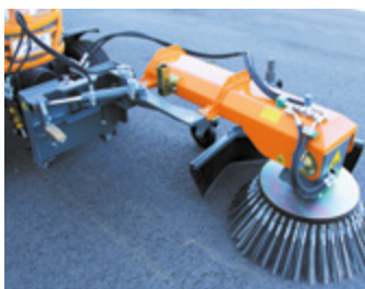
Dispositif de pivotement hydraulique, vers la gauche 85 °
