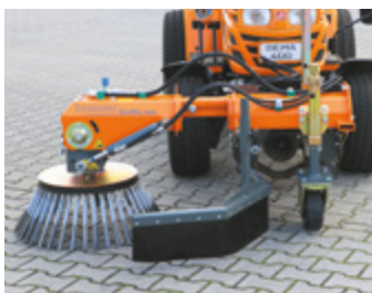
Polyvalent grâce au déplacement latéral télescopique (300 mm)
