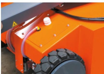
Maschinengehäuse mit integriertem Wassertank inkl. Füllstandsanzeige
