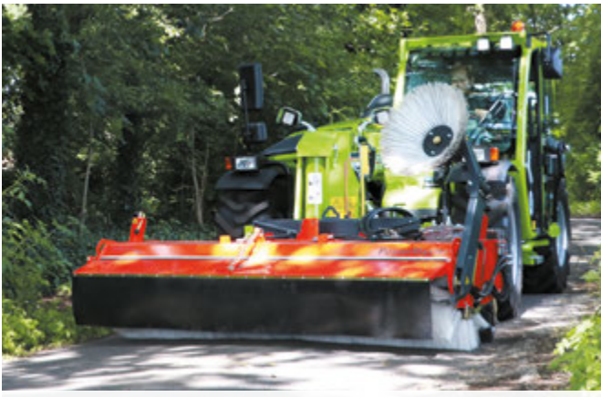
bema 30 Dual PowerMaster ohne Schmutzsammelwanne (Freikehren)
