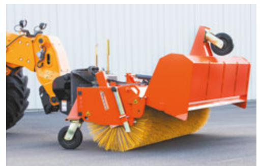
bema 30 Dual PowerMaster am Radlader, Schmutzsammelwanne Dual geöffnet
