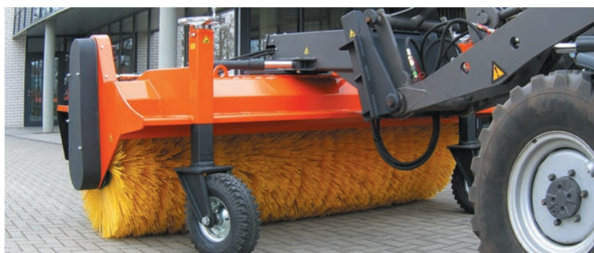
bema Jumbo montée sur chargeur (logement à changement rapide et compensation d'oscillation)
