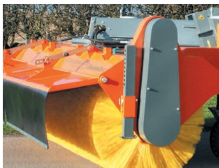
Carter de chaîne (entraînement latéral par chaîne)
