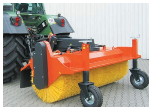
bema Jumbo, montage sur tracteur (trois points / à l'arrière)
