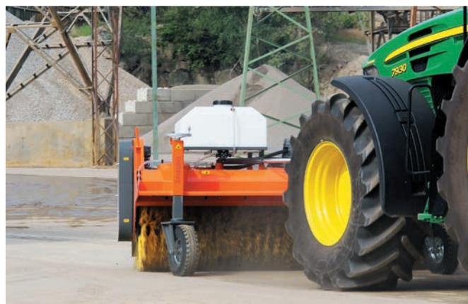
bema Jumbo, montage sur tracteur (à l'avant)
