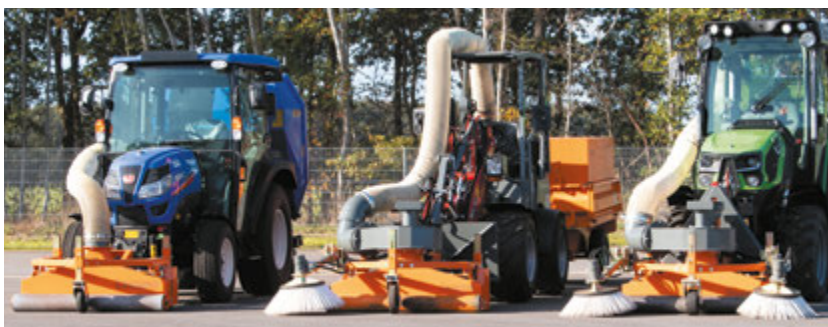
bema Saug-Kehrdüse in Frontanbau ohne/mit Häckselgebläse in Kombination mit vorhandenem Saugcontainer oder Sammelanhänger im Heck (Fremdsysteme)
