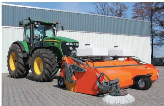
bema Titan Dual monté sur tracteur (attelage frontal)
