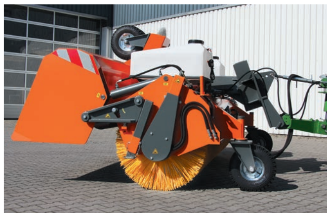
Bac de ramassage ouvert (balayer à bac relevé)
