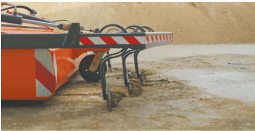
Aufkratzschiene unterteilt in Hardoxsegmente
