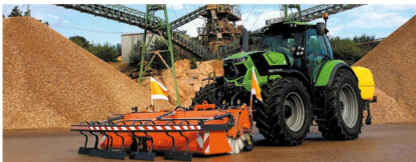
bema Aufkratzvorrichtung mit Schmutzsammelwanne in Kombination mit bema Hochdrucksprülanlage und Wassertank (2000 Liter) im Heck
