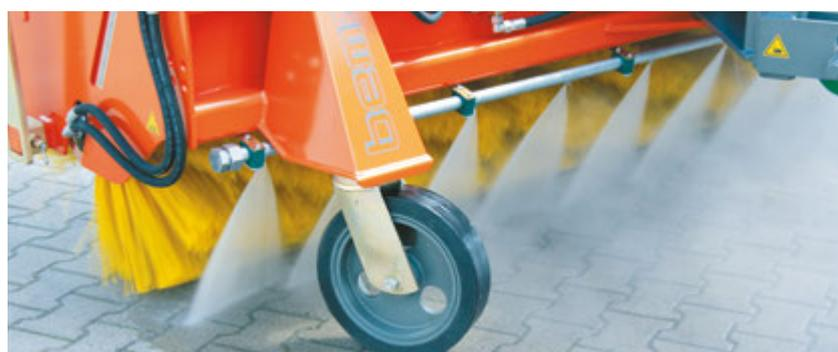
Hochdruckspülanlage - je nach Maschinenbreite bis zu 11 Hochdruckdüsen
