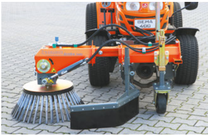
Flexibel dank der teleskopierbaren seitlichen Verschiebung (300 mm)
