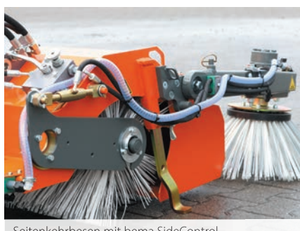
Seitenkehrbesen mit bema SideControl und Wassersprüheinrichtung
