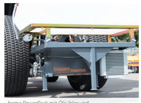
bema PowerPack mit Ölkühler und Wassertank im Heck
