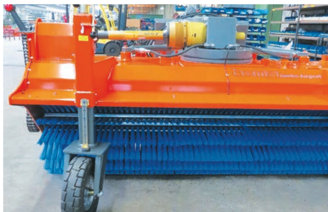
bema Jumbo Airport - les roues sont réglables en hauteur en continu
