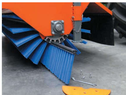
Système à cassettes avec éléments de brosse
