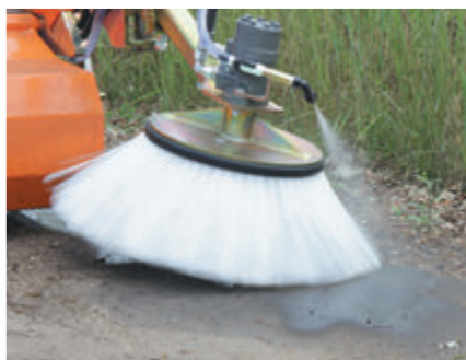
Seitenkehrbesen mit Wassersprüheinrichtung
