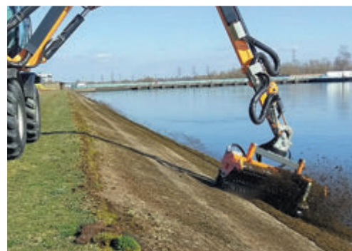
bema 25 mit Wildkrautbürste, Anbau Bagger (Sonderbau)
