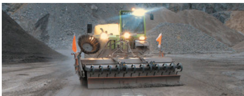
bema 75 Dual PowerMaster mit Aufkratzvorrichtung anstatt Schmutzsammelwanne, Seitenkehrbesen, Hochdruckspülanlage und Wassertank im Heck
