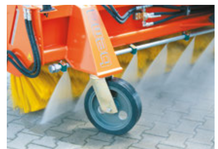
Stabile Super-Elastik-Vollgummiräder mit Gussradkörper, Hochdruckspülanlage
