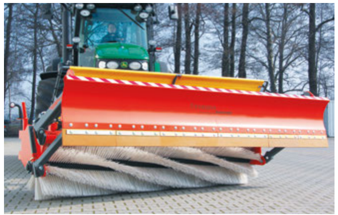
bema Snow-Combi mit hochgeklapptem Schneeschild - Freikehren
