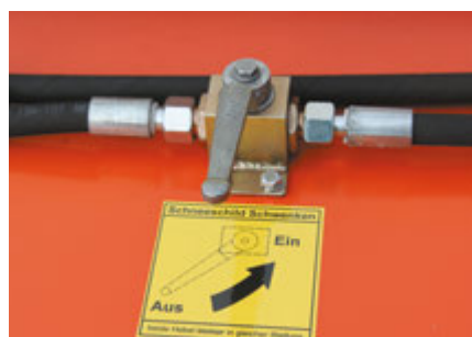
Absperrhahn zum Verriegeln des hochgeklappten Schneeschildes
