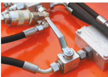
Schwenkdrossel & Mengenteiler (gleichmäßiges Anheben des Schneeschildes)
