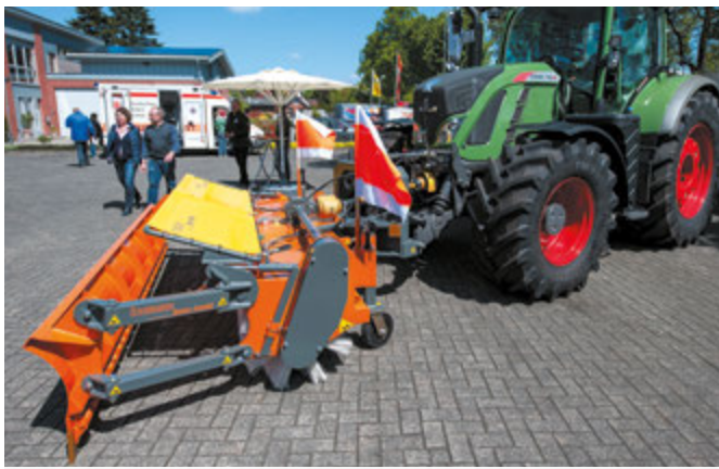
bema Snow-Combi am Schlepper mit optionalem Schneestaubschutz
