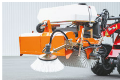
bema 20 Dual in Vollausrüstung, Schmutzsammelwanne im bewährten Dual-System
