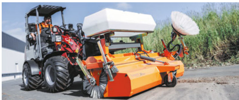
bema 20 Dual mit Wassersprüheinrichtung und Seitenkehrbesen
