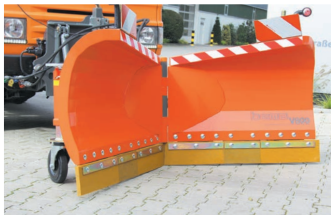
Lame à neige en V bema V800 en position Y
