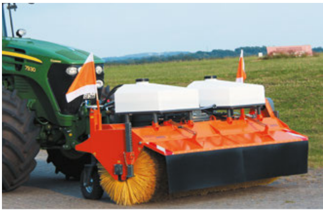
bema Jumbo angebaut am Schlepper (Front)
