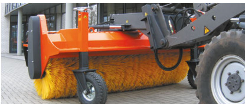
bema Jumbo am Radlader (Schnellwechselanbau mit 2D-Rollenniveaueausgleich)
