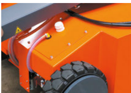
Maschinengehäuse mit integriertem Wassertank inkl. Füllstandsanzeige
