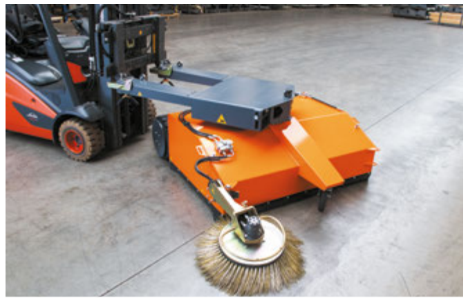
Extrem wendig durch zentralen Lenkpunkt für exaktes Kehren
