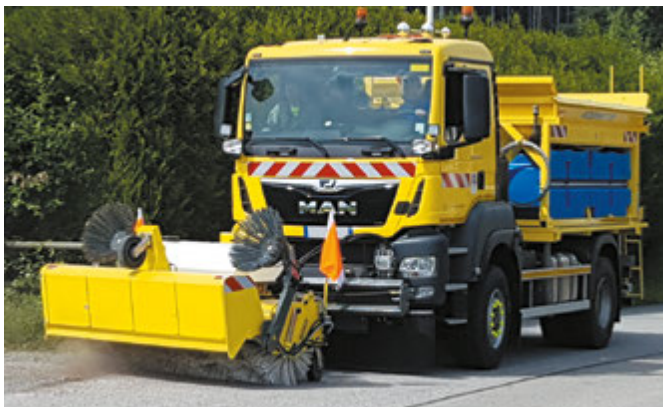
bema 35 Dual PowerMaster mit hydraulischer Seitenverschiebung (Schmutzsammelwanne geöffnet, Freikehren)
