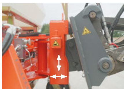
3D-Ausgleich und optionales Drehgelenk zur Erweiterung des 3D-Ausgleichs
