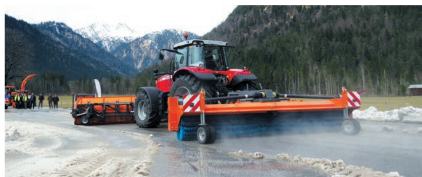
La bema Jumbo Airport Turbo se singularise par sa largeur de travail de 5200 mm
