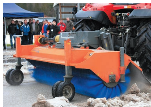
bema Jumbo Airport Turbo montage sur tracteur (à l'arrière)
