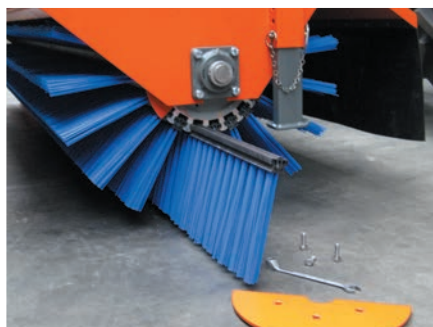
Système à cassettes avec éléments de brosse
