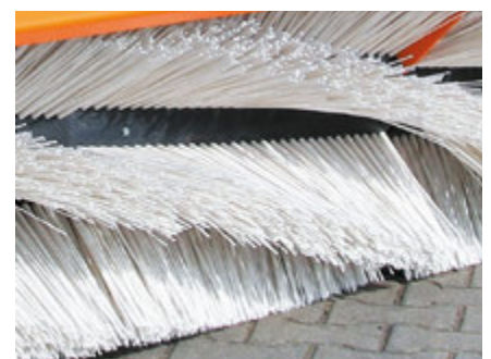
Schneekehrwalze PPN (Spiralsegmentbesatz)
