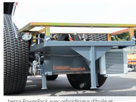
bema PowerPack avec refroidisseur d'huile et réservoir d'eau montage à l'arrière
