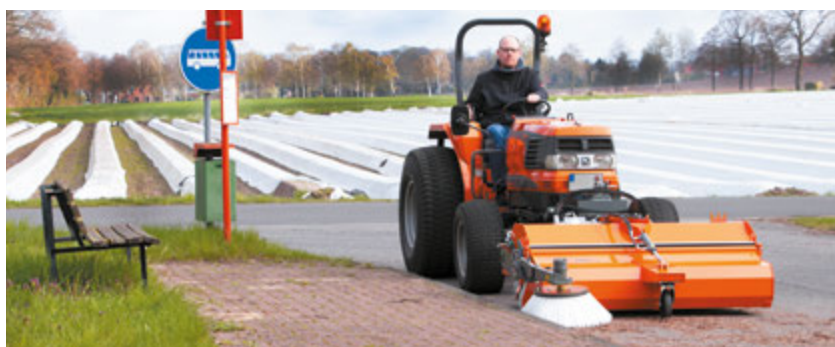
bema Kommunal 580 Dual mit Seitenkehrbesen - optimal für Bordsteine, Rinnsteine und an Gebäuden
