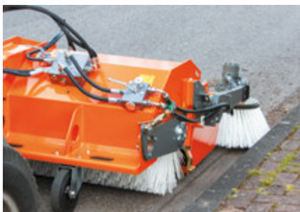
Hydroblock und Seitenkehrbesen mit bema SideControl
