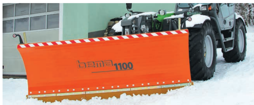
Lame à neige bema série 1100, sur chargeuse télescopique (plaque de montage rapide)
