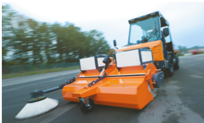
bema Sweezy® 580 Dual E ausgestattet mit einem mechanisch angetriebenem Seitenkehrbesen und einer Wassersprüheinrichtung mit 2 x 64 Liter Wassertanks
