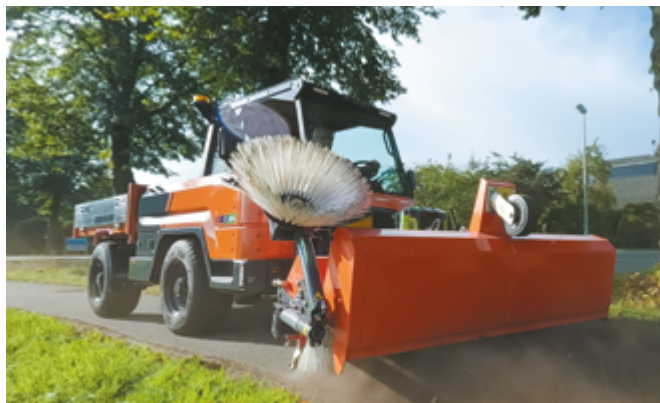
bema Sweezy® 580 Dual E mit Schmutzsammelwanne im bewährten Dual-System, hier Freikehren bei geöffneter Schmutzsammelwanne
