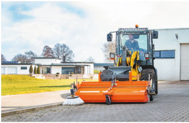
bema Sweezy® 25 Dual WD, optional mit Seitenkehrbesen
