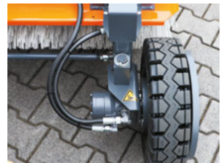
Effizienter lenkbarer Radantrieb (hydraulisch)
