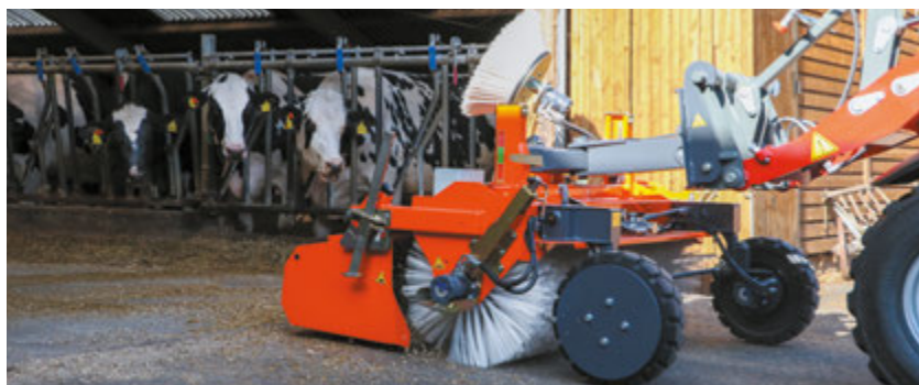
Mit zwei lenkbaren Radantrieben ist die Kehrmaschine unabhängig vom Trägerfahrzeug
